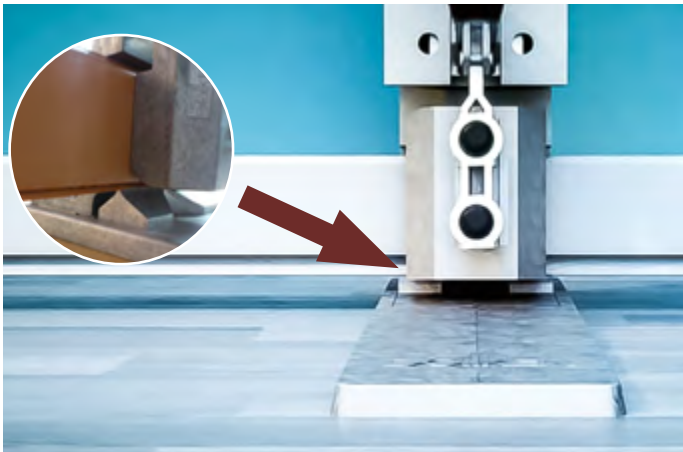
Dabei die flexible Dachlippe gerade auf den Stützbock legen
